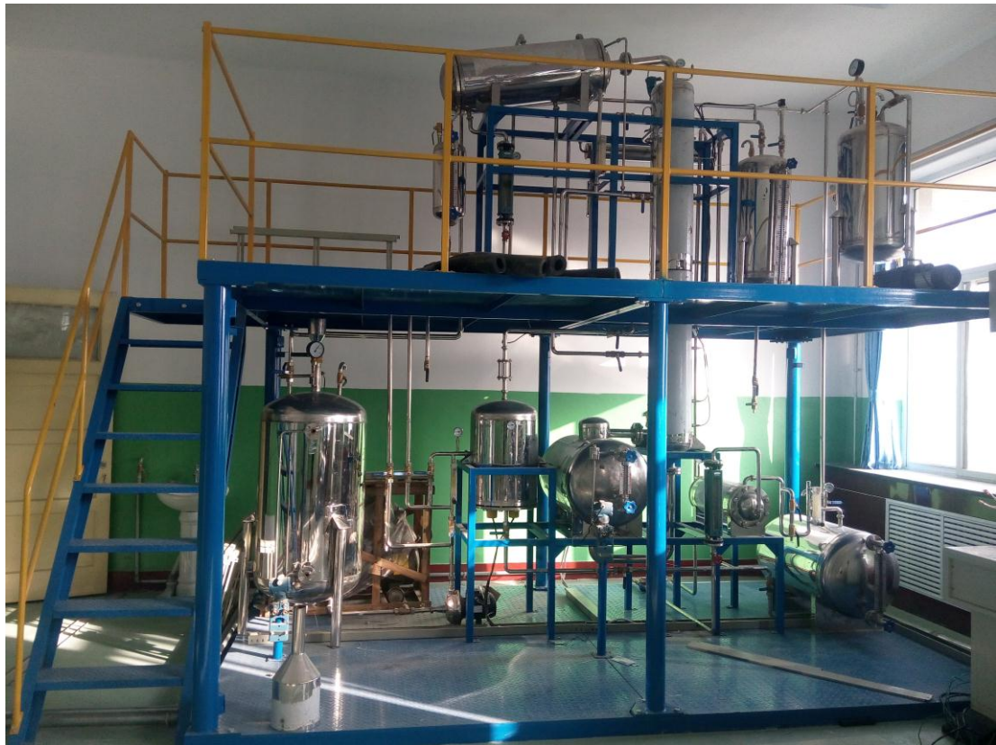
化工总控工培训与竞赛装置（精馏实训操作装置）
